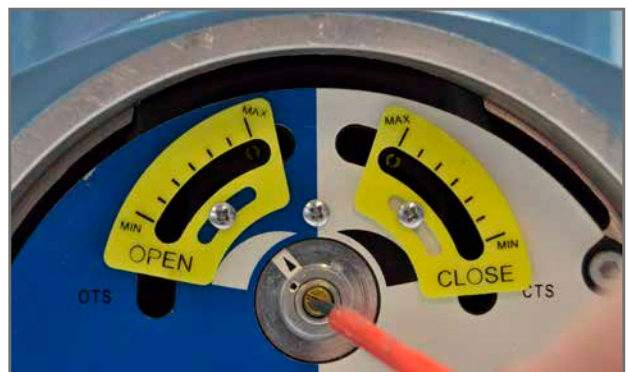
Ajuste del tornillo del embrague de la leva de par.
