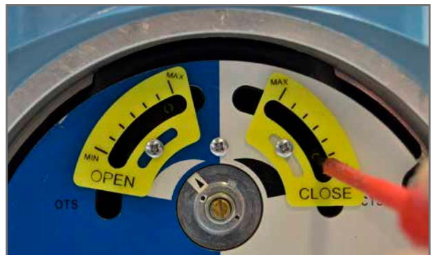
Ajuste de la configuración del par de cierre.
