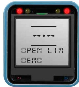
Indicación de límite de apertura en el Centronik.
