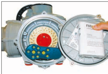
Рис. 7.3.2 Клеммный блок привода (Пульт настройки упаковывается отдельно в упаковочной коробке).
