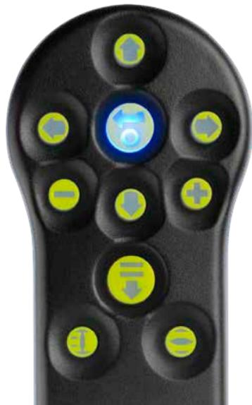
Sono mostrati di seguito i relativi tasti di navigazione e configurazione per la taratura di un attuatore della gamma IQ.
