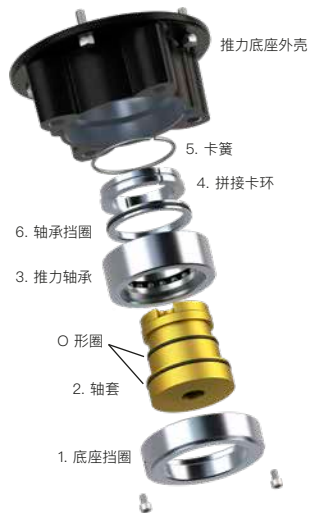
Fig. 5.1.3 F14 & F16 底座拆解图
