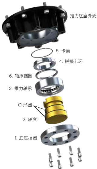
Fig. 5.1.4 F25 & F30 底座拆解图
