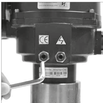
Still inn mot klokken for å lukke stoppeskruen
